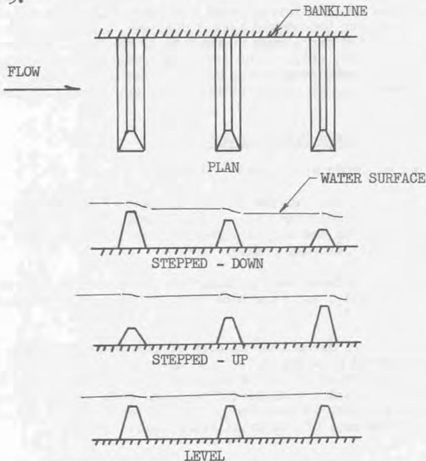
FIGURE 7 - LONGITUDINAL PROFILE DESIGN
