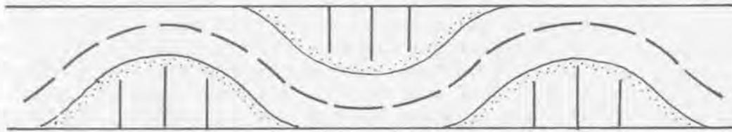
FIGURE 11 - PROPER DIKE SEQUENCE
